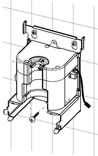
6. Der weiche Gummischlauch am Pumpenstutzen montieren und nachher die Pumpe in den Seifenbehälter platzieren.
